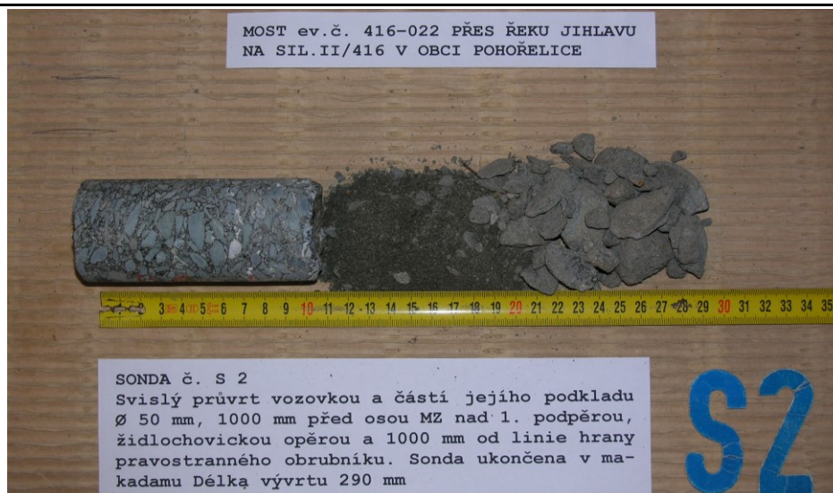
Obr. G20-2: SONDA č. S2. Svislý průvrt vozovkou a částí jejího podkladu Ø50/100 mm, 1000 mm před osou MZ nad 1. podpěrrou, židlochovickou opěrrou a 1000 mm od linie hrany pravostranného obrubníku. Sonda ukončena v makadamu. Délka vývrtu 290 mm.
