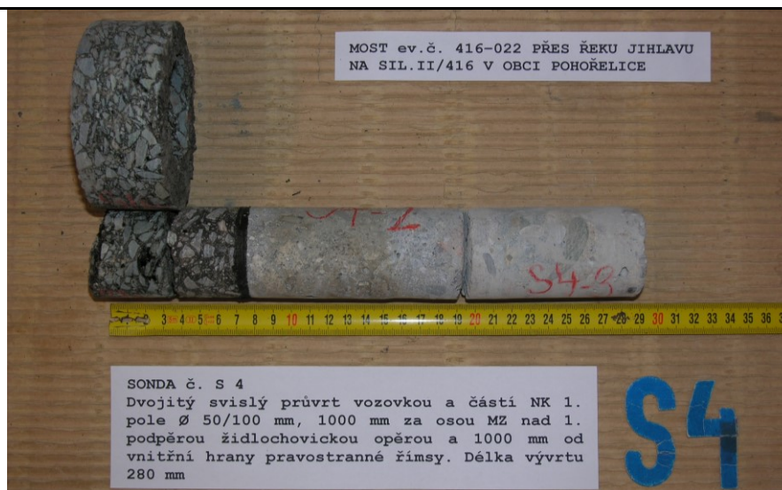
Obr. G20-4: SONDA č. S4. Dvojitý svislý průvrt vozovkou a částí NK 1. pole Ø50/100 mm, 1000 mm za osou MZ nad 1. podpěrrou, židlochovickou opěrrou a 1000 mm od vnitřní hrany pravostranné římsy. Délka vývrtu 280 mm. Hydroizolace není poškozena.
