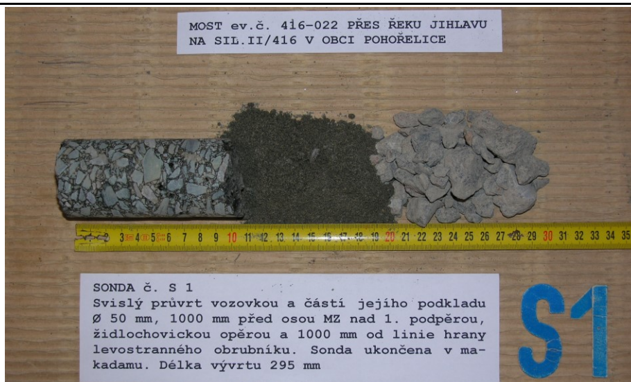
Obr. G20-1: SONDA č. S1. Svislý průvrt vozovkou a částí jejího podkladu Ø50/100 mm, 1000 mm před osou MZ nad 1. podpěrrou, židlochovickou opěrrou a 1000 mm od linie hrany levostranného obrubníku. Sonda ukončena v makadamu. Délka vývrtu 295 mm.
