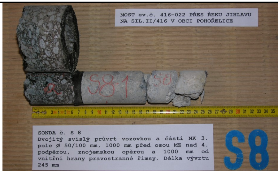
Obr. G20-8: SONDA č. S8. Dvojitý svislý průvrt vozovkou a částí NK 3. pole Ø50/100 mm, 1000 mm před osou MZ nad 4. podpěrrou, znojemskou opěrrou a 1000 mm od vnitřní hrany pravostranné římsy. Délka vývrtu 245 mm. Hydroizolace poškozena částečně v mezivrstvě a částečně odtržena od pečetící vrstvy.
